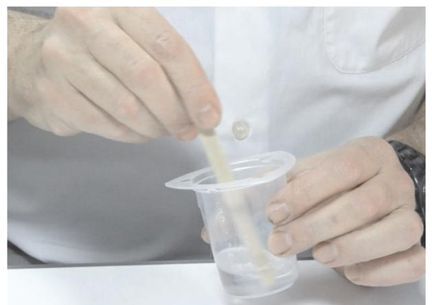
placé sur une balance. Cela suffit pour coller 6 lames. On peut doubler les doses pour réaliser une série de 12 à 15 lames, mais il est déconseillé de préparer plus de mélange en une seule opération car le durcisseur agit tout de suite et rend l'utilisation difficile de la colle au bout de 15 minutes.
