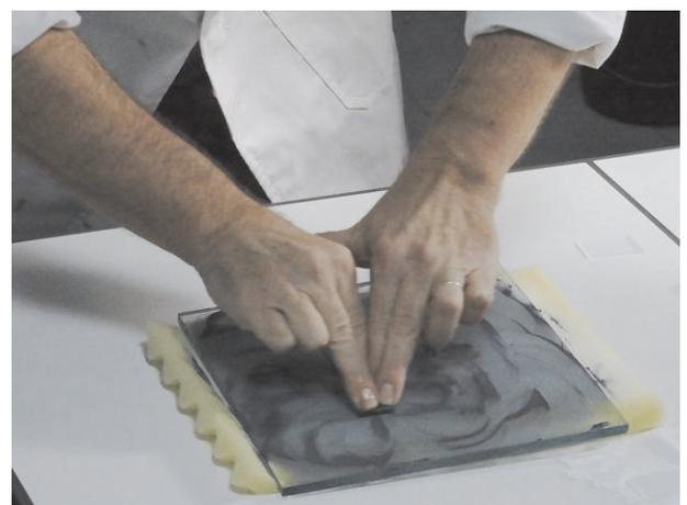
rotatifs réguliers qui couvrent toute la surface du carreau de manière homogène. On a trop souvent tendance à utiliser plus le centre que la périphérie. Afin que l'action sur l'échantillon soit uniforme et crée une planéité parfaite, il faut le faire tourner d'un quart de tour toutes les trente secondes environ.
